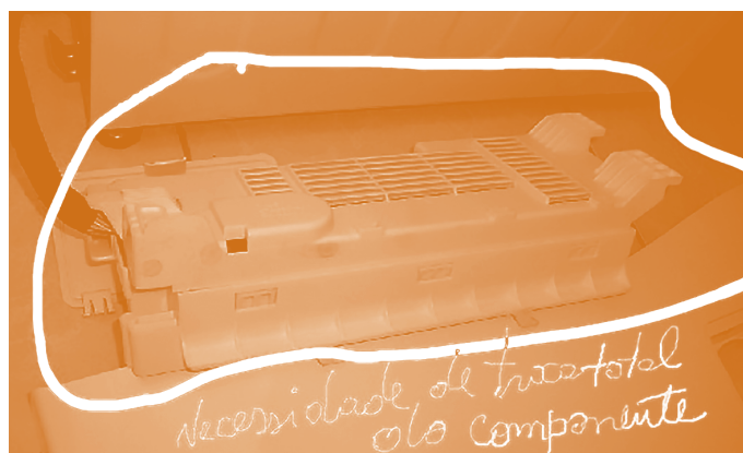
FIG. 7 Sistema de Controle em que não é possível trocar apenas o componente defeituoso; faz-se necessário trocar o todo (conjunto), logo, o todo (conjunto = sistema) passa a ser o componente passível de troca. Fonte: Wilson Kindlein Júnior.
