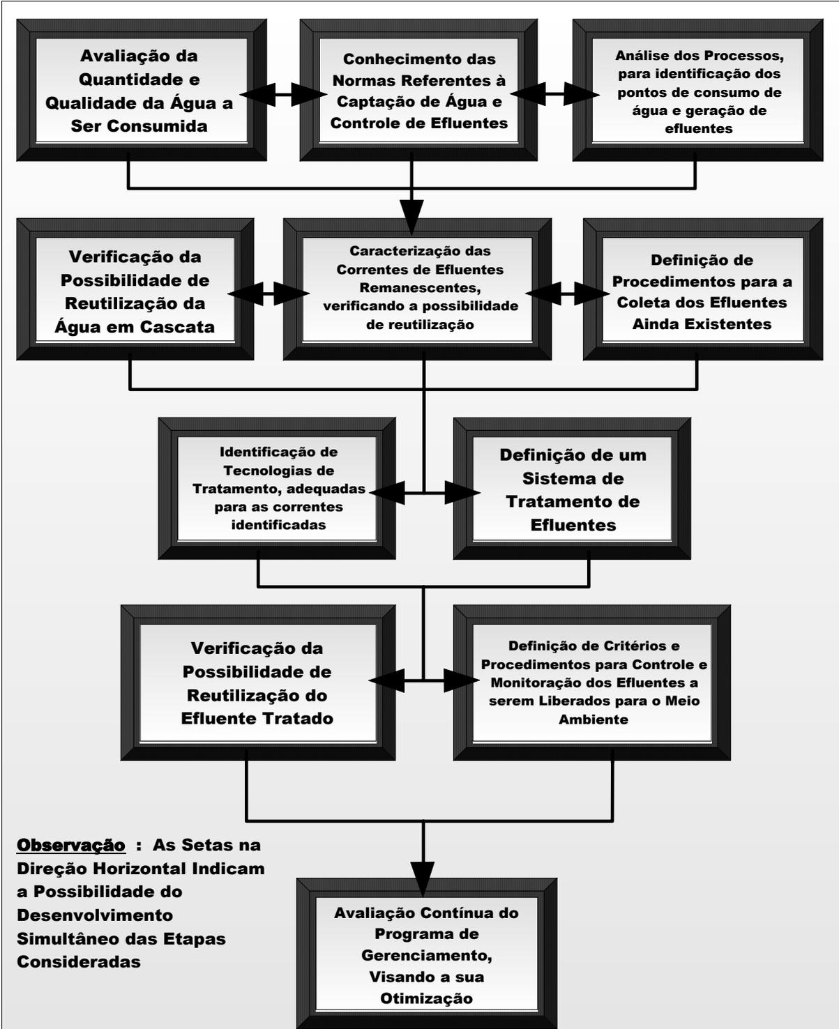
**Figura - 2: Representação das Etapas de Gerenciamento de Águas e Efluentes**
